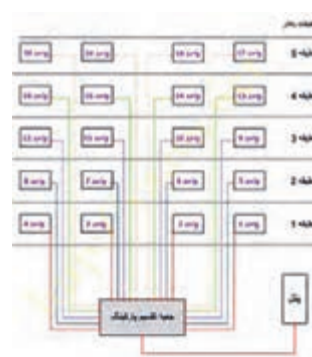
الف- نقشه سیم کشی درب باز کن
